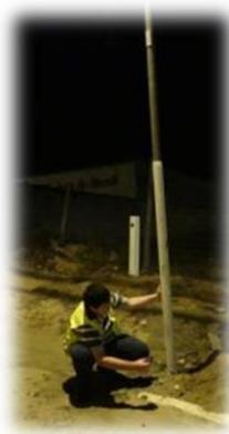
Imagem AB – Medição de altura de instalação da luminária em relação ao solo.
