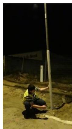
Imagen AB – Medição de altura de instalação da luminária em relação ao solo.
