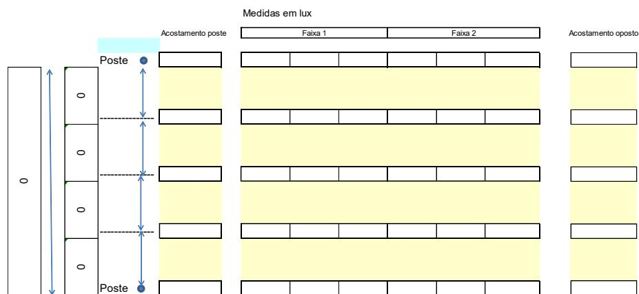
Com base nas medições realizadas, pode-se calcular os valores de iluminância média, e uniformidade da iluminância, comparando-os aos valores estabelecidos pela NBR 5101 – Iluminação Pública, definindo assim, o atendimento ou não do trecho “tipo” aos valores normatizados.
