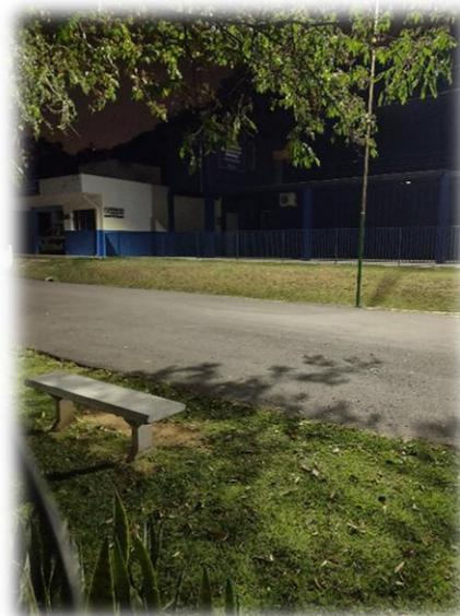
Para este setor indica-se a manutenção das luminárias com defeito e complemento de iluminação com postes de 6 metros de altura direcionadas para a pista de caminhada utilizando luminárias LED branca com 5000 K de temperatura de cor.
